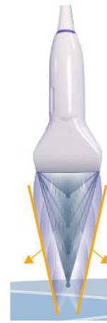
Force de radiation créée par SonicTouch™. L'onde de cisaillement est amplifiée le long d'un cône de Mach (en jaune), la distance parcourue est augmentée minimisant ainsi l'énergie acoustique utilisée
